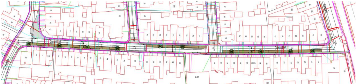
Figuur 4. Herziene schetsontwerp van 9 november 2022 met daarin 10 bomen. De locatie van kabels en leidingen is zichtbaar in rood, blauw, groen en paars (op basis van klic-analyse).
